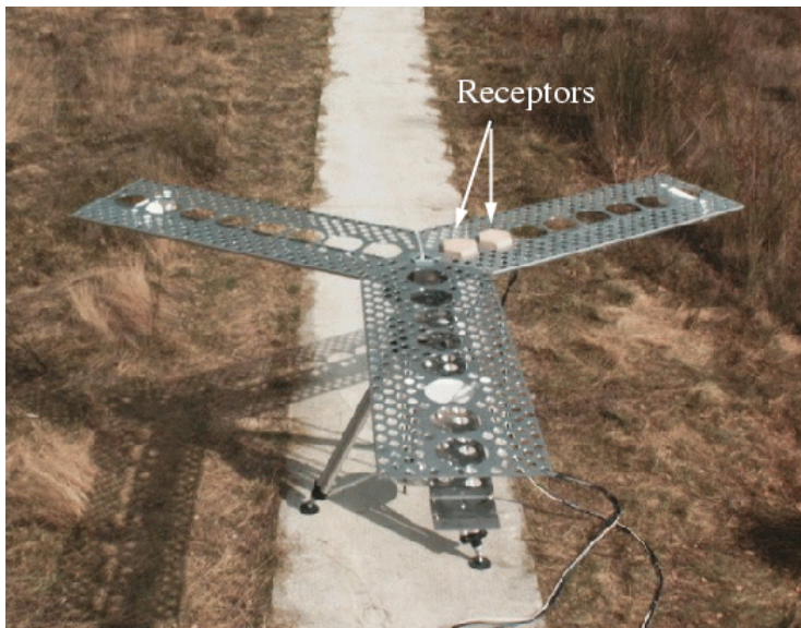
Imatge: Prototipus del radiòmetre MIRAS utilitzat durant la campanya de mesures a Dwingeloo.
